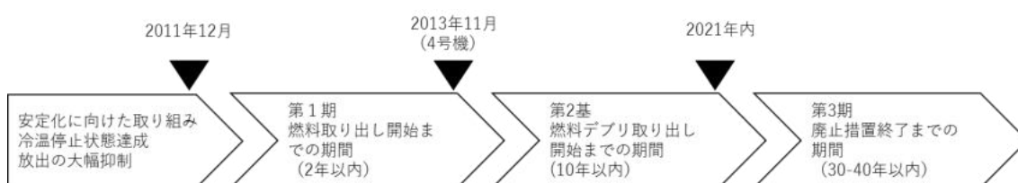
図6-5 廃炉作業の全体工程の概略
