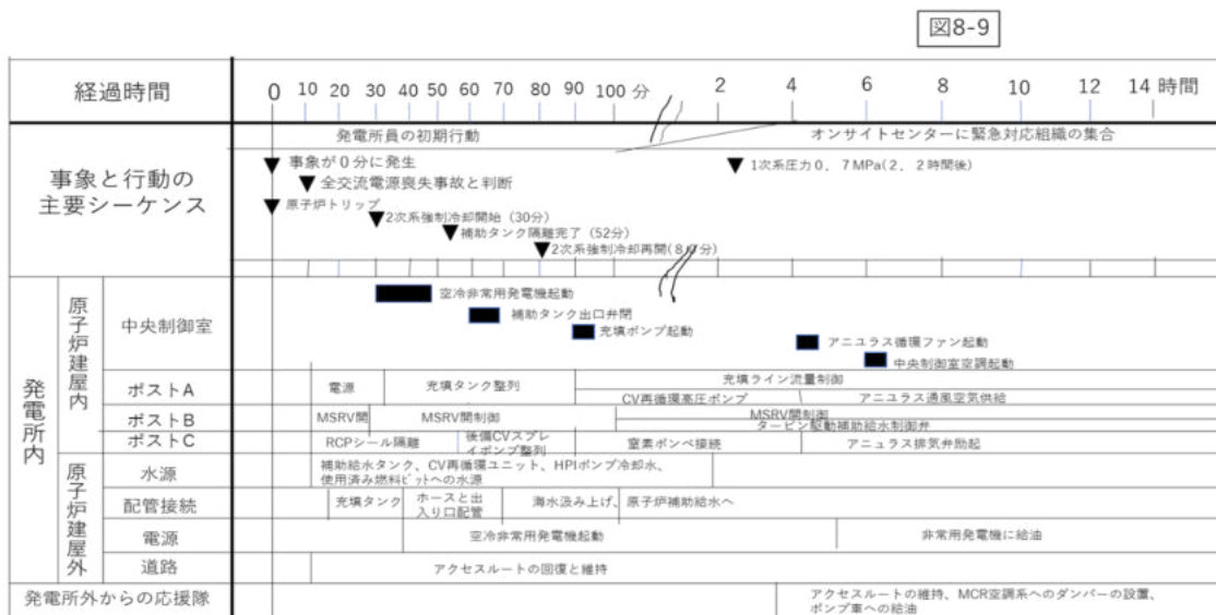
図 8－9 シビアアクシデント事故発生時の原発サイト内緊急時対応組織の班別行動のグラフ表示 (出典：Hidekazu Yoshikawa (2016) Reinforced measures of severe accident prevention for restarting Japanese PWR plants after Fukushima accident, Nuclear Safety and Simulation, 7(1), 2016, page 16 に掲載の Fig.10 を日本語化した。)
